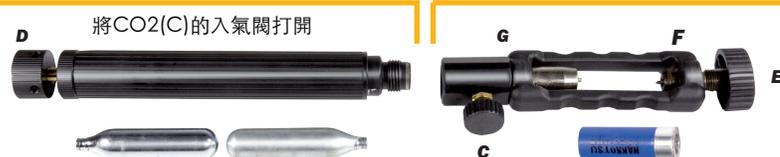
4 接著旋開E處零件，隨後將彈殼裝入，但需注意方向，活塞必須在F處，底殼則是朝向G處。下一步便將E處再次旋緊，確保彈殼置入正確。
